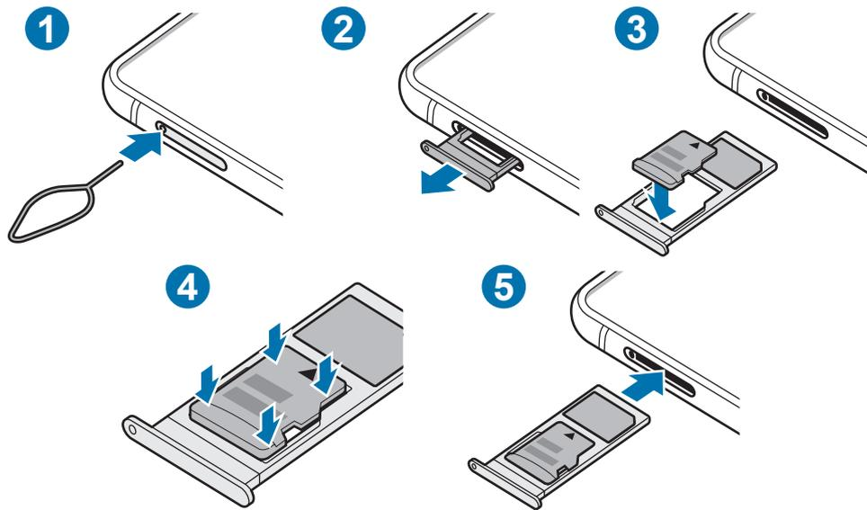
1 Para extraer la bandeja de la tarjeta SIM, inserte la anilla de extracción en el orificio de la bandeja.
