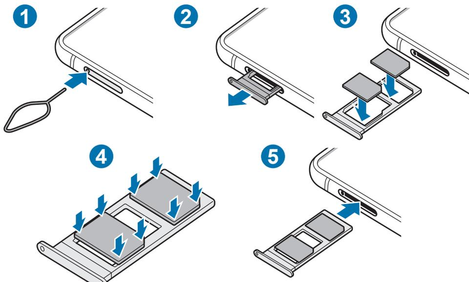
1 Para extraer la bandeja de la tarjeta SIM, inserte la anilla de extracción en el orificio de la bandeja.
