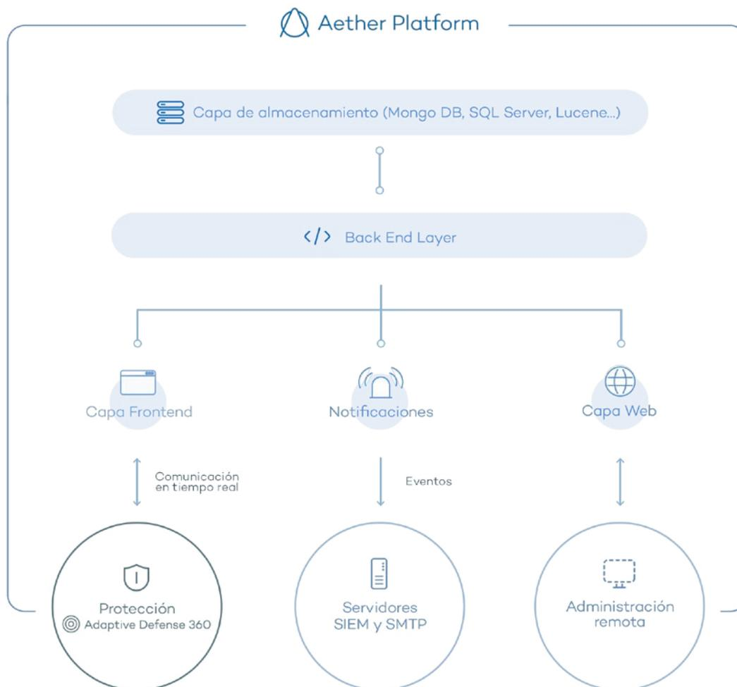
Figura 2: estructura lógica de la **plataforma Aether**
