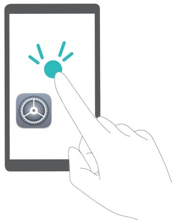
Por ejemplo, si desea abrir **Ajustes**, pulse el icono **Ajustes** una vez con un dedo y, a continuación, pulse dos veces cualquier parte de la pantalla.
