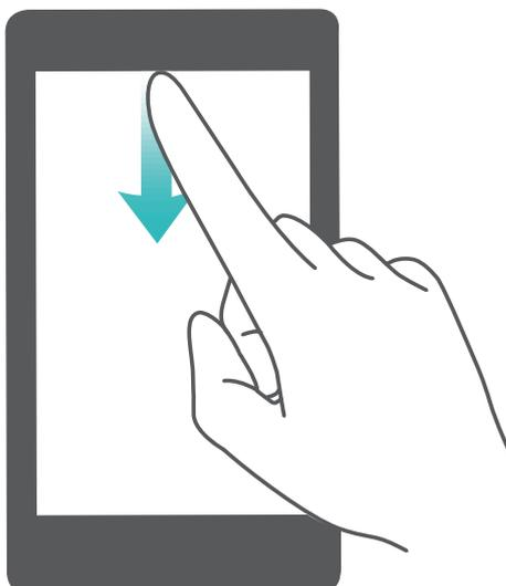
**Acceso al panel notificaciones con la pantalla desbloqueada:** Deslice el dedo hacia abajo sobre la barra de estado para abrir el panel de notificaciones. Puede activar o desactivar los selectores de accesos directos o pulsar las notificaciones para ver los detalles.
