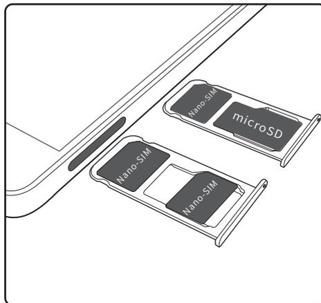
**3** Inserte una tarjeta SIM o una tarjeta microSD en la bandeja para tarjetas.
