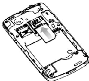
3. Abra el receptáculo de sujeción para tarjetas microSD, sujete la tarjeta microSD por la esquina cortada y deslícela en el interior.
