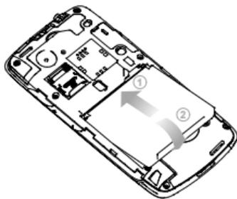
5. Vuelva a colocar la cubierta en su sitio y presiónela suavemente hasta que oiga un clic.
