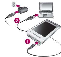
Para cargar el teléfono mediante el adaptador de corriente
