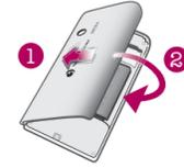
1 Fije el lateral izquierdo de la tapa de la batería alineándola con los orificios situados en el lateral trasero izquierdo del teléfono.
