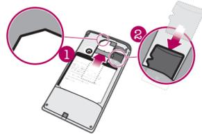
• Introduzca la tarjeta SIM y la tarjeta de memoria con los contactos dorados mirando hacia abajo.
