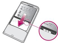
• Inserte la batería con las etiquetas de uso de la batería mirando hacia abajo y los conectores mirándose entre sí.
