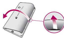
• Inserte la punta del dedo o un objeto fino en la abertura lateral del teléfono, entre el teléfono y la tapa de la batería, y retire la tapa lentamente.
