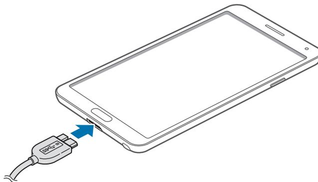
Cuando utilice un cable USB 2.0, conéctelo a la parte derecha de la clavija multifunción, como se muestra en la siguiente imagen.
