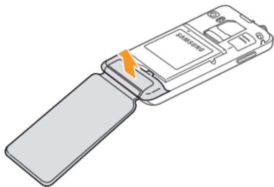
3 Vuelve a colocar la cubierta inferior y la cubierta trasera.
