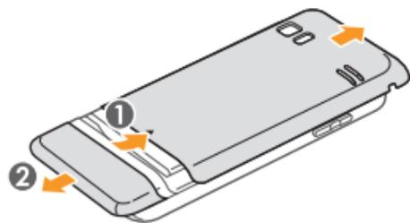
2 Coloque la tapa de cuero y presiónela hasta que encaje.
