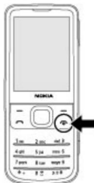
Para encender o apagar el teléfono, mantenga pulsada la tecla de encendido.
