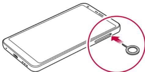
2 Tire de la bandeja de tarjetas usando el alfiler.
