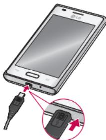
**NOTA:** debe realizarse una primera carga completa para mejorar la vida útil de la batería.
