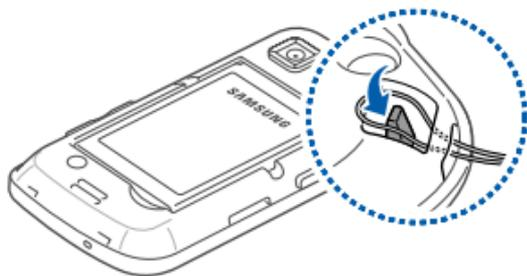
3. Coloque nuevamente la cubierta de la batería.
