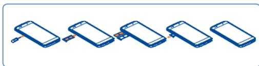
Antes de instalar o extraer la tarjeta SIM/microSD, utilice un alfiler para presionar la pequeña cavidad y hacer salir la bandeja de la SIM.
