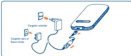
Conecte el cargador de la batería a su teléfono y enchufe eléctrico respectivamente.
