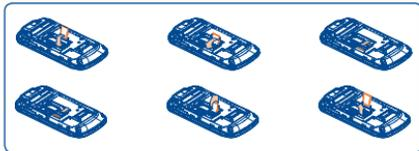
Para quitar la tarjeta microSD, desplácela en la dirección de la flecha y levántela. Luego, introduzca la tarjeta microSD con el contacto dorado hacia abajo. Finalmente, baje el soporte de la microSD y deslicelo en dirección opuesta para cerrarla.
