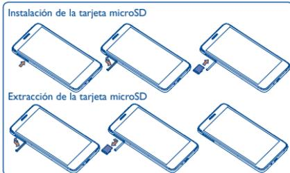
Inserte la tarjeta microSD en la ranura con los contactos dorados hacia abajo hasta que quede bloqueada. Para quitar la tarjeta microSD, presione suavemente hasta que quede desbloqueada.
