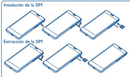
Inserte a tarjeta SIM en la ranura con el chip hacia abajo hasta que quede bloqueada. Para quitarla, empuje suavemente la tarjeta SIM hasta que quede desbloqueada.
