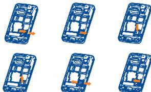
Inserte la tarjeta microSD externa en la ranura con el contacto dorado mirando hacia abajo. Para extraer la tarjeta microSD externa, presiónela y deslicela hacia afuera.
