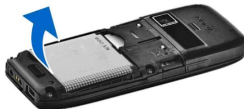
3. Inserte la tarjeta SIM. Asegúrese de que la zona de contacto de la tarjeta esté orientada hacia los conectores del dispositivo y que el extremo biselado esté orientado hacia la parte superior del dispositivo.
