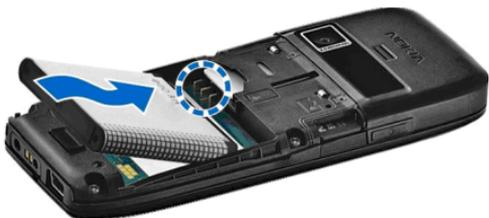
5. Deslícela hacia abajo hasta que encaje.
