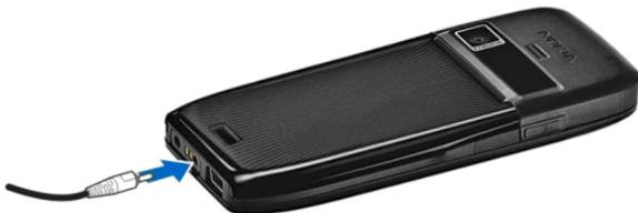
Conecte el cable de alimentación al dispositivo. Si la batería se ha agotado totalmente, puede pasar un rato antes de que el indicador de carga empiece a moverse.
