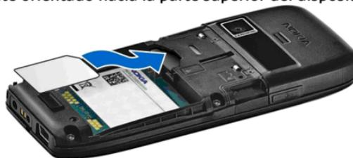
4. Inserte la batería. Alinee los contactos de la batería con los conectores correspondientes del compartimento de la batería e insértela en la dirección de la flecha.
