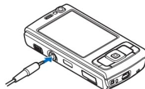
No conecte productos que creen una señal de salida ya que esto podría dañar el dispositivo. No conecte ninguna fuente de voltaje al conector Nokia AV.
