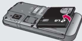
**⚠ ADVERTENCIA:** No extraiga la batería con el teléfono encendido, ya que podría dañarlo.
